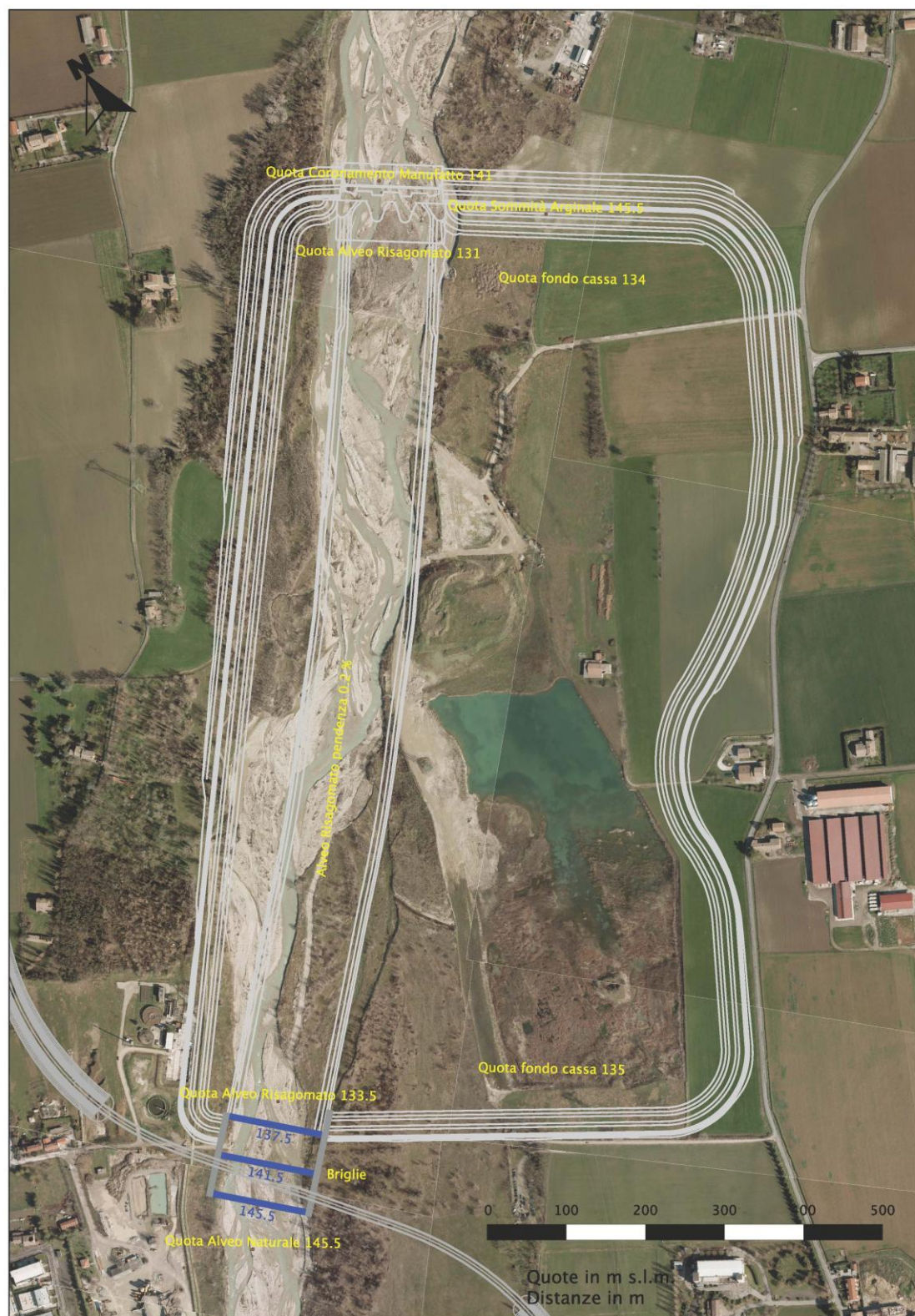
Figura 5-5 – Configurazione e principali quote di progetto della cassa di espansione.
